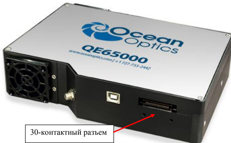
Расположение 30-контактного разъема на корпусе спектрометра QE65000
