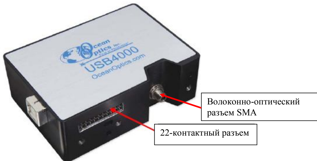
Расположение 22-контактного разъема на корпусе спектрометра USB4000
