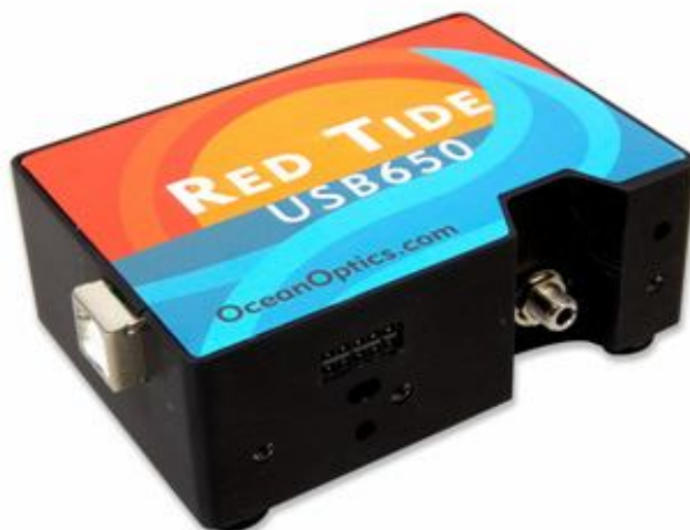
Внешний вид спектрометра USB-650
