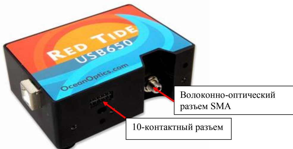
Расположение 10-контактного разъема на корпусе спектрометра USB-650
