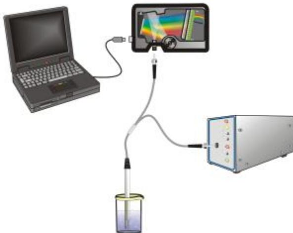
Измерение пропускания широко применяется для определения концентрации веществ в растворах, а также определения характеристик светофильтров, оптических покрытий и других оптических элементов (например, линз, световодов).
